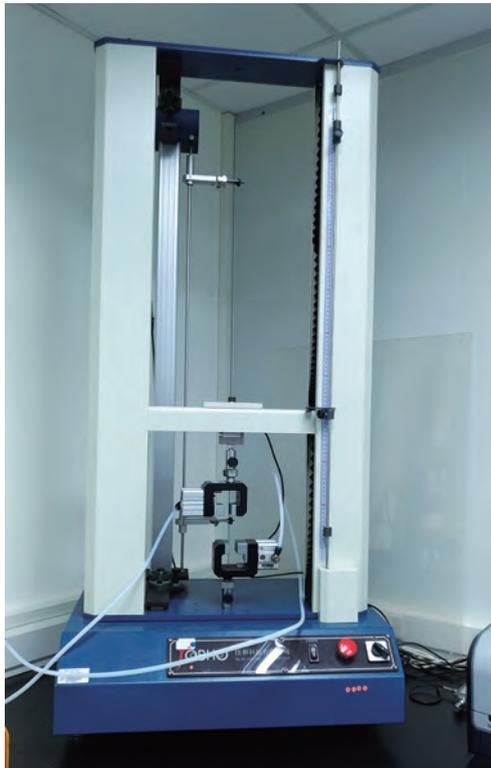
雙柱式拉力試驗機
